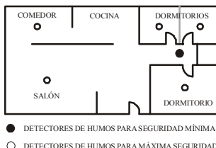
Figura 1: INSTALACIÓN DE LOS DETECTORES DE HUMOS EN VIVIENDAS UNIFAMILIARES CON UNA SOLA ZONA DE DORMITORIOS.
