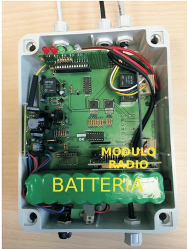
El módulo que contiene la CPU de la sirena puede ser desmontado para su correcta programación, quitando los dos tornillos de la parte inferior de la sirena.
